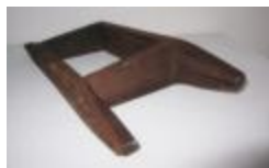
handsteenvorm voor conische steen (HMT7009 )
